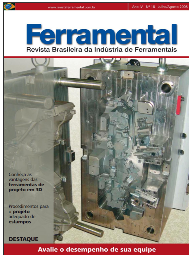
Figura 1 – Matriz de Ferramentaria presente na capa da Revista Ferramental. No detalhe, um molde de injeção de carcaça de farol.
