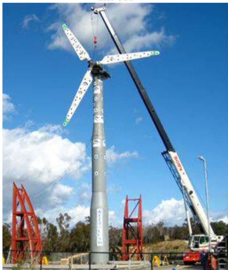
Figura 17 – Aerogerador de 65kW posicionada para o ensaio de mesa sísmica da UCSD - LHPOST
