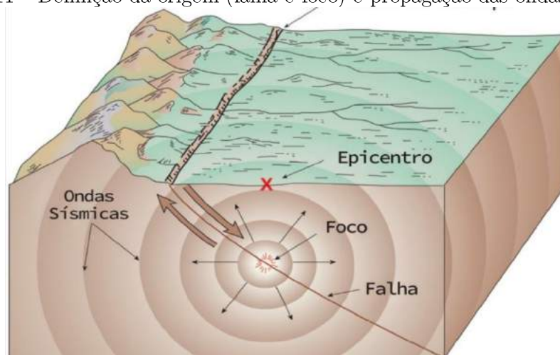
Figura 11 – Definição da origem (falha e foco) e propagação das ondas sísmicas
