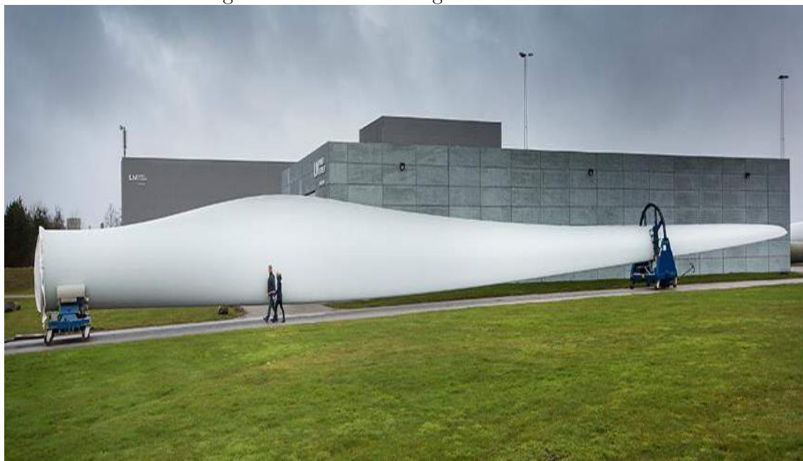
Figura 5 - Pá de um aerogerador GE 1.5MW
