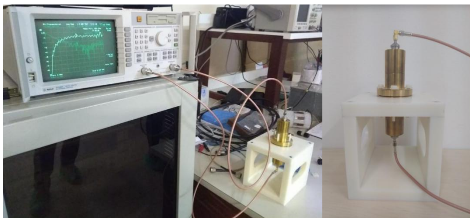
Figura 44 - Montagem do Equipamento para análise da EB dos filmes compósitos
