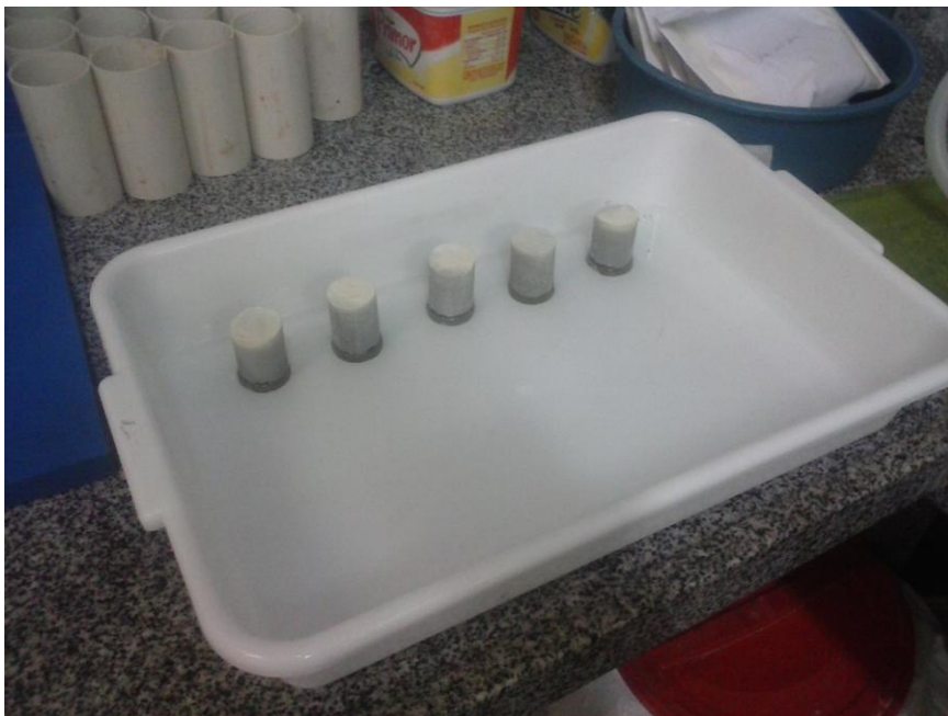
Figura 17. Esquema do ensaio de absorção de água
