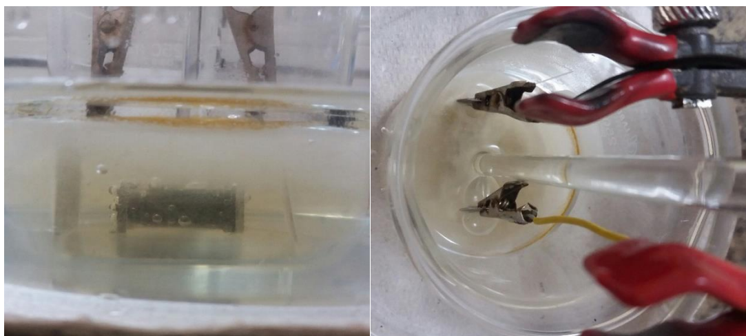
Figura 26 - Migração dos íons para a solução eletrolítica.
