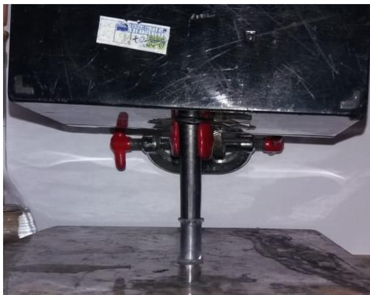
Figura 18 - Prensagem do grafite em pó no recipiente EBP (tubo ependorf ).
