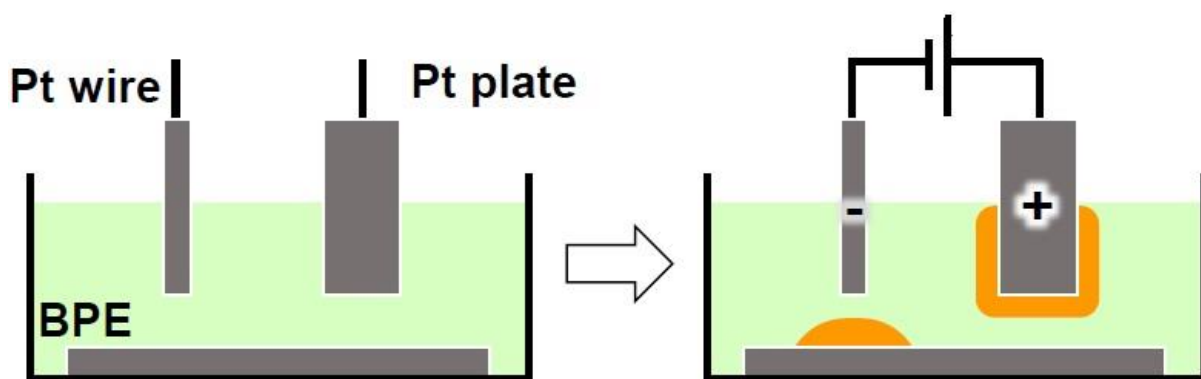
Figura 7 – Deposição de hidrogél em áreas específicas no eletrodo bipolar (INO et al. , 2018).
