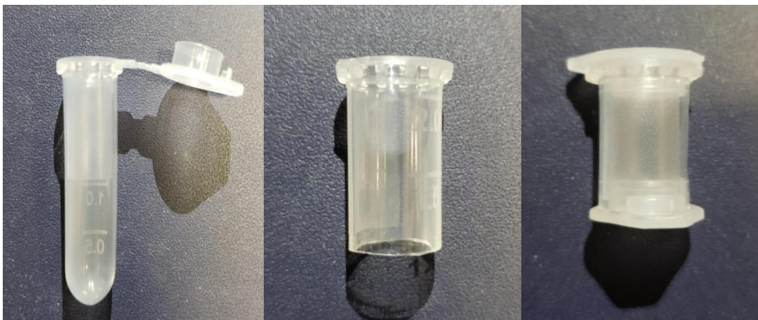
Figura 16. Etapas da preparação do recipiente EBP para conter o grafite em pó.
