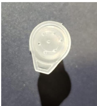
Figura 17 - Visão da extremidade do tubo ependorf após a etapa dos furos.
