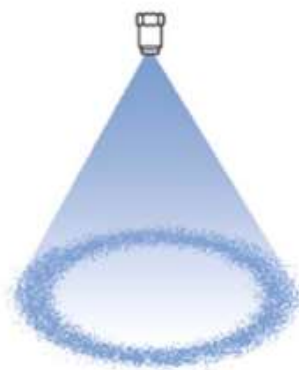
Figura 32 - Representação de bico aspersor do tipo cone oco ( hollow cone ).
