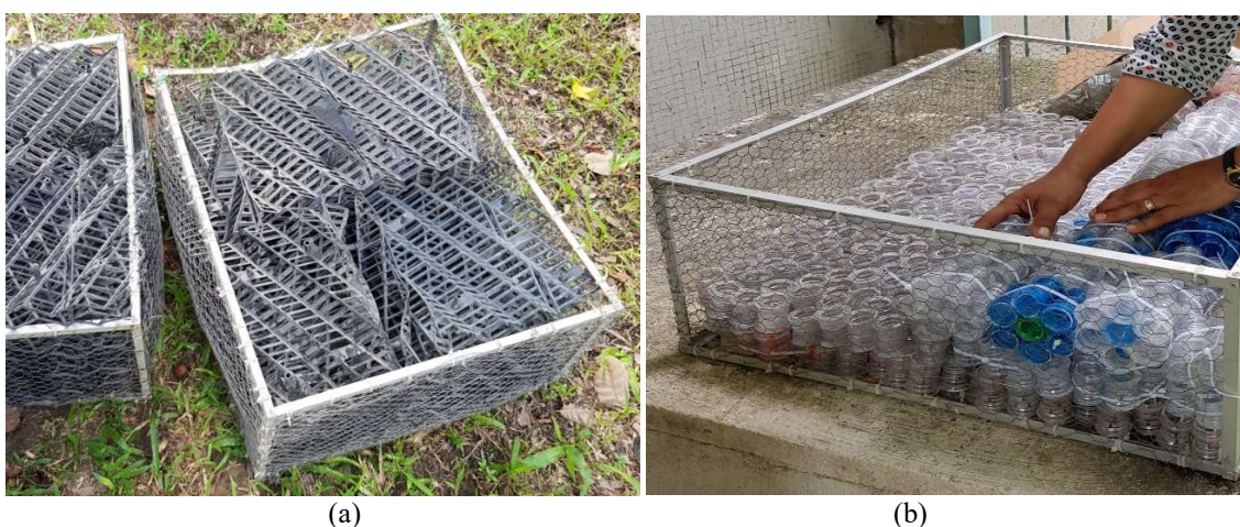
Figura 20 - Montagem do enchimento industrial (a) e do enchimento com gargalos PET (b)
