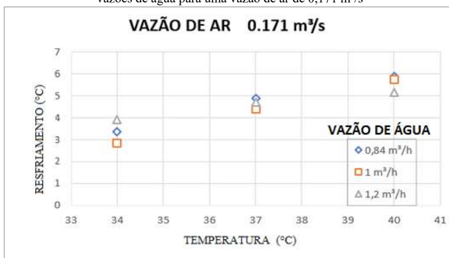
Figura 42 - Resfriamento ( ^{\circ}\text{C} ) versus temperatura ( ^{\circ}\text{C} ) para o enchimento com gargalos - Comparação entre vazões de água para uma vazão de ar de 0,171 \text{ m}^3/\text{s}
