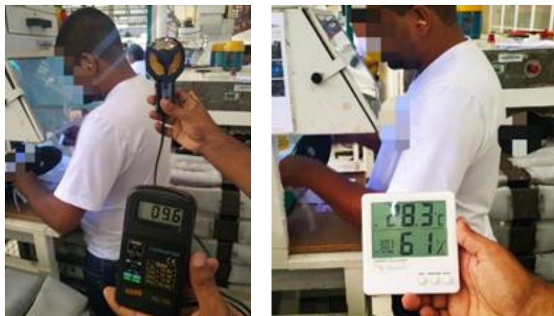
Figura 14 – Medições da velocidade do ar e umidade relativa.
