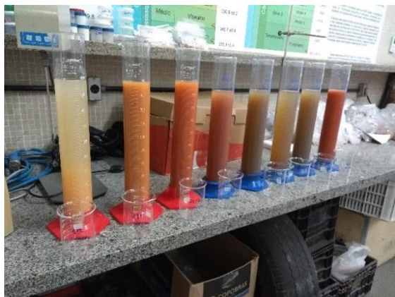
Método da pipetagem para os valores de silte e argila
