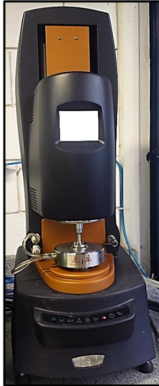
Figura 17: Reômetro utilizado para as medidas reológicas desse trabalho.
