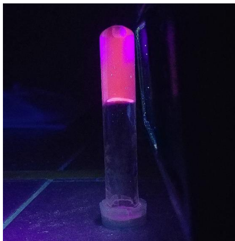
Figura 31: Foto dos géis aerogéis de európio do sistema Asp/IDA quando irradiados sob lâmpada UV.
