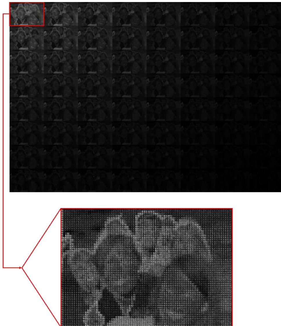
Figura 31 – Espectro da 4D-DCT (visualizado de forma bidimensional) de uma imagem de light field (canal Y) calculado com blocos de tamanho 8 \times 8 \times 8 \times 8 e o frame na posição s = 0 e t = 0 ampliado.
