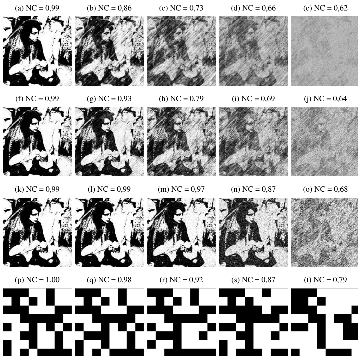
Figura 53 – Marcas d’água extraídas por percentual de coeficientes retidos. Todas estas marcas foram inseridas na última faixa de coeficientes (frequências altas). Foram extraídas marcas de tamanho 2048 \times 2048 – (a), (b), (c), (d) e (e) –, 1024 \times 1024 – (f), (g), (h), (i) e (j) –, 512 \times 512 – (k), (l), (m), (n) e (o) – e 8 \times 8 – (p), (q), (r), (s) e (t). Os percentuais de coeficientes retidos foram: 30%, 20%, 10%, 5% e 1% para as marcas de tamanho 2048 \times 2048 ; 10%, 7%, 5%, 3% e 1% para as marcas de tamanho 1024 \times 1024 e 512 \times 512 ; 5%, 4%, 3%, 2% e 1% para as marcas de tamanho 8 \times 8 .
