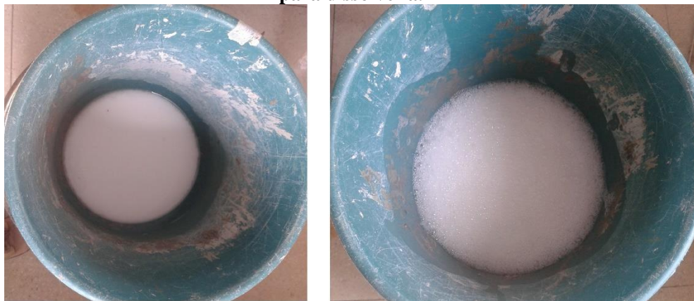
Figura 11 – (a) Cola branca colocada no balde; (b) Aspecto da cola branca com adição de água para dissolvê-la.
