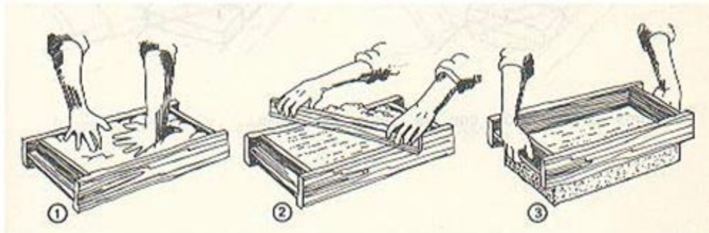
Figura 5 – Moldagem dos blocos de adobes.
