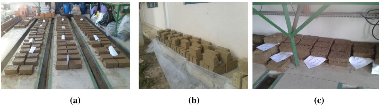
Figura 14 – Secagem e armazenamento dos tijolos.
