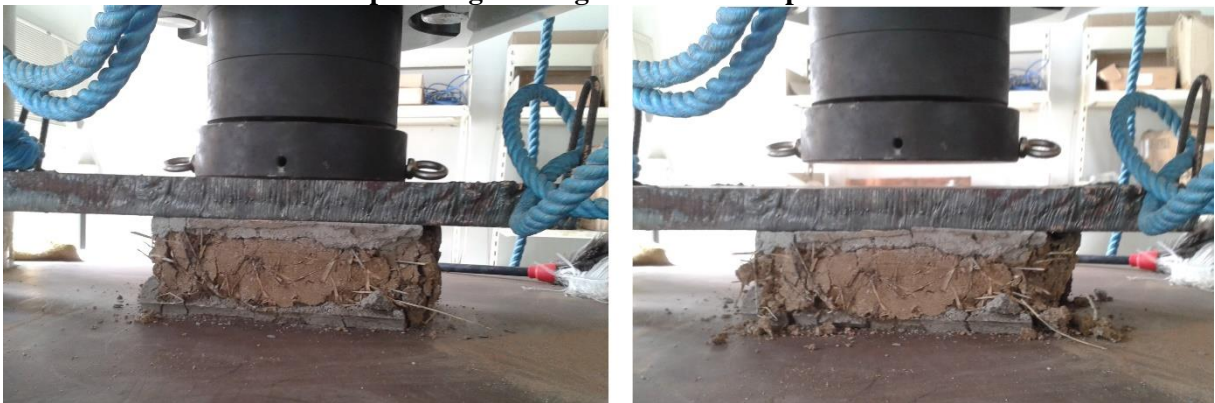
Figura 36 – (a) Aspecto do tijolo ao atingir a carga de ruptura máxima; (b) Aspecto do tijolo após atingir a carga máxima de ruptura.
