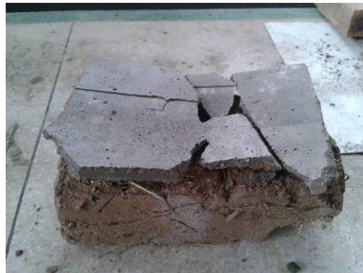
Figura 21 – Quebra do capeamento da superfície inferior do tijolo.
