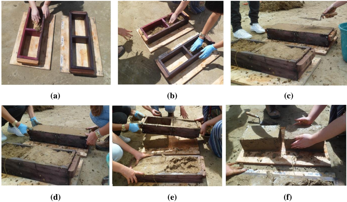
Figura 13 – Processo de moldagem dos tijolos: (a) Formas fixadas nas superfícies planas de madeira; (b) Colocação da mistura nas formas; (c) Alisamento da superfície do tijolo; (d) Preparação para desmoldagem; (e) Desmoldagem dos tijolos; (f) Aspecto final do tijolo logo após desmoldagem.
