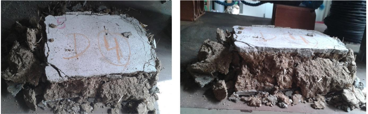
Figura 37 – (a) Vista superior do tijolo após execução do ensaio; (b) Vista lateral do tijolo após execução do ensaio.
