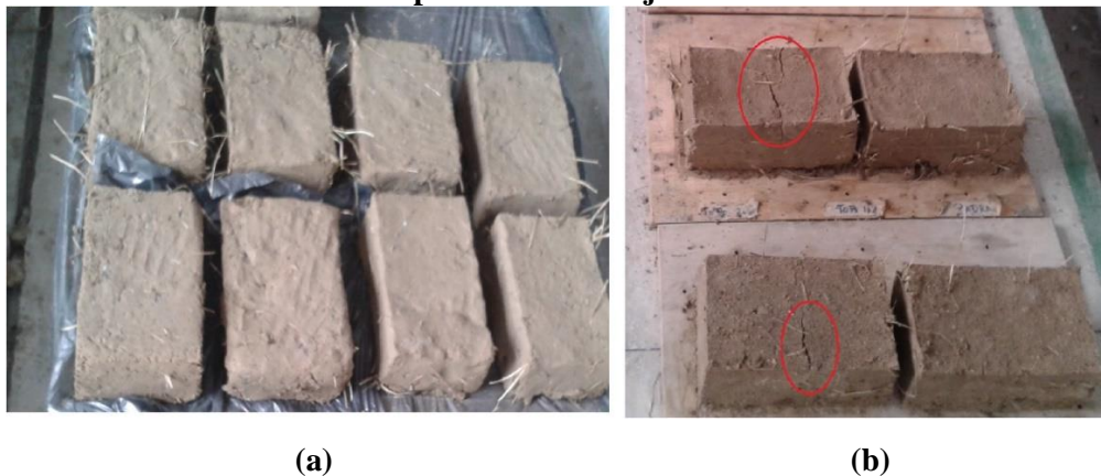
Figura 15 – (a) Deformações apresentadas nos tijolos; (b) Destaque das trincas e fissuras que apareceram nos tijolos.
