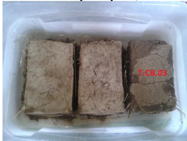
Figura 33 – Percolação total da água por capilaridade no tijolo do traço T.CB.03 (primeiro da direita para esquerda).
