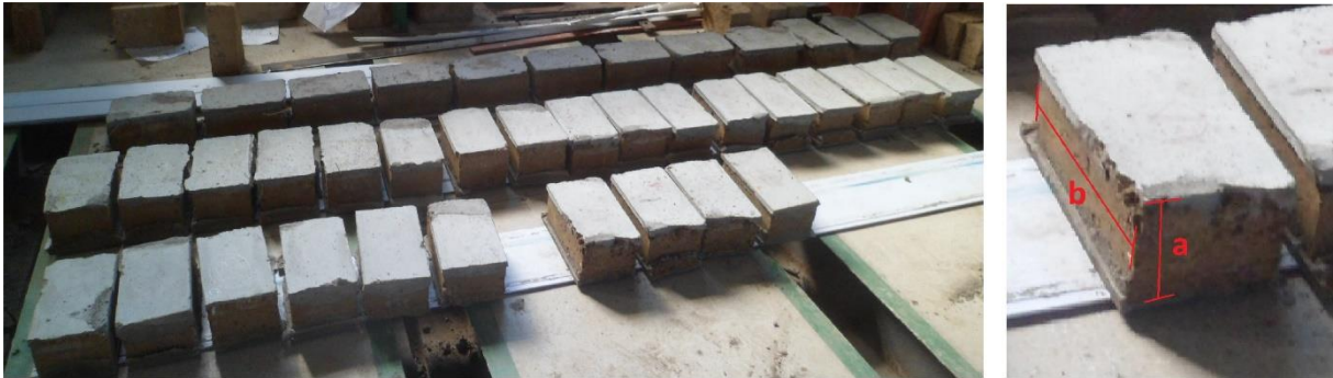
Figura 22 – (a) Tijolos prontos para medição; (b) Medição das dimensões.
