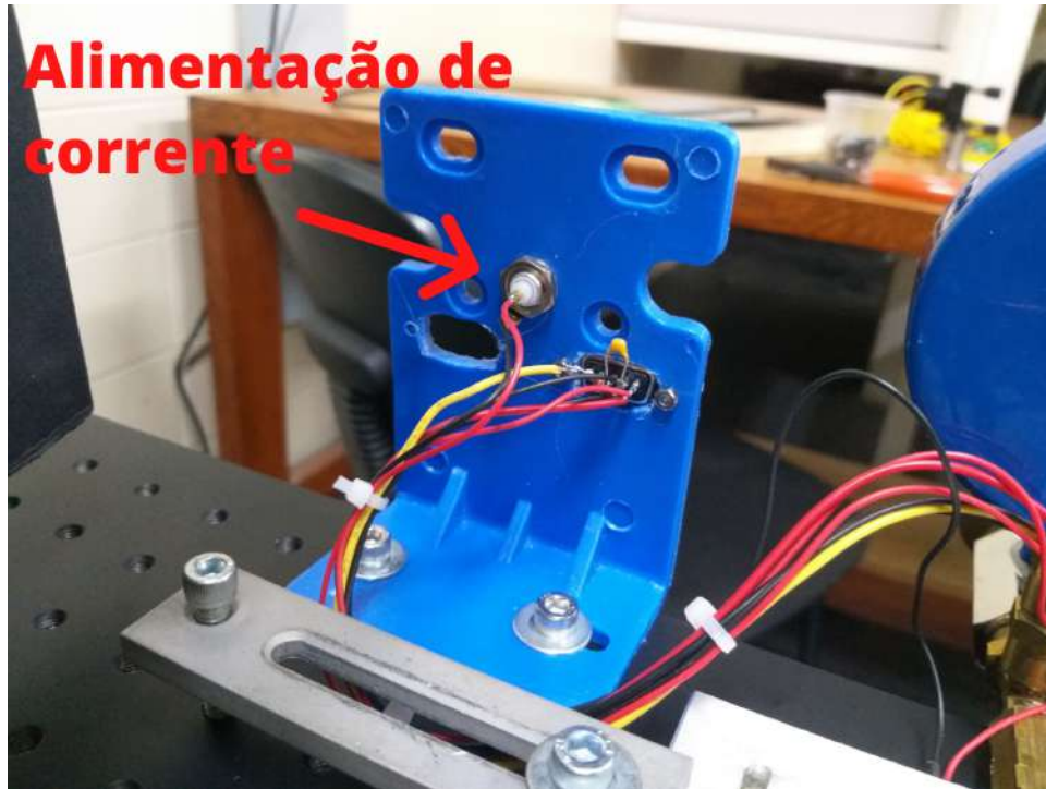
Figura 20 – Montagem de um painel eletrônico para ligações dos controladores de corrente e temperatura e alimentação do diodo, LM35 e peltier.
