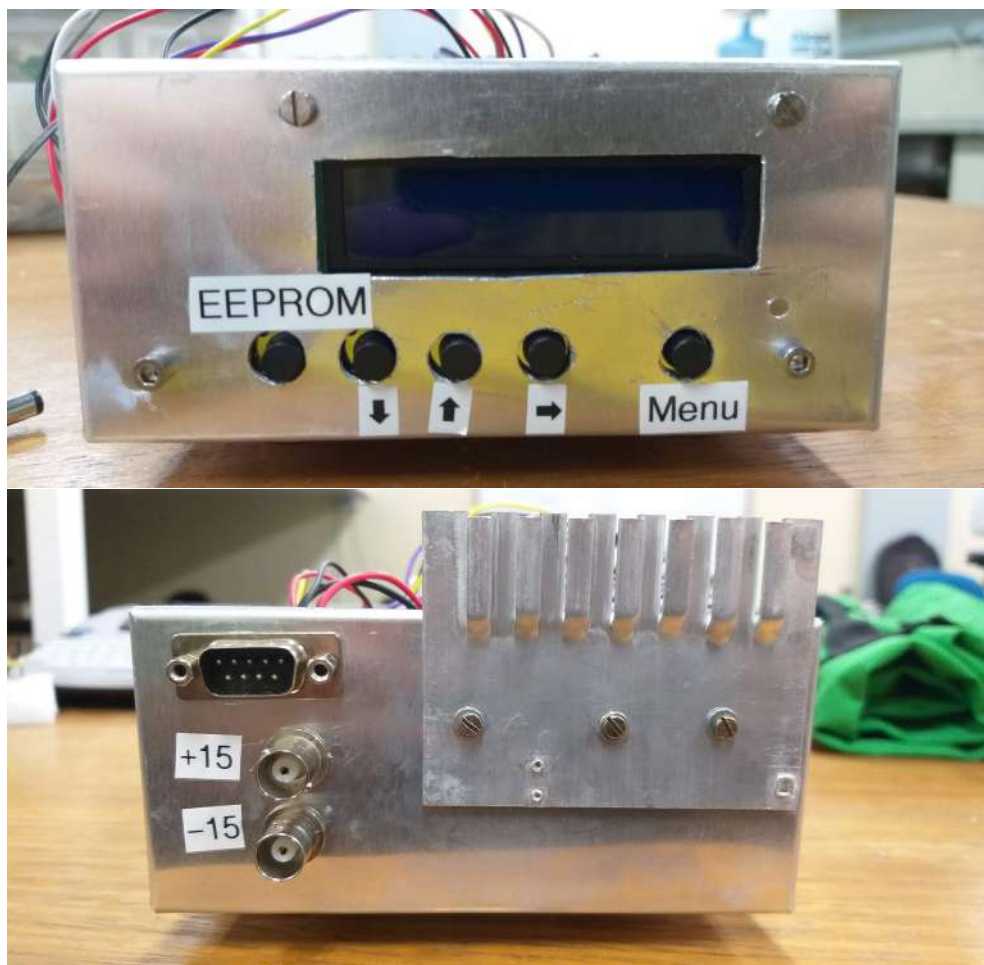
Figura 34 – Visão frontal e traseira do novo controlador de tempertarua. Um botão EEPROM é requerido para salvar e atualizar os últimos valores de T_0 e \beta assumidos no programa. O botão de MENU acessa as configurações do programa para mudar valores do proporcional e temperatura de setpoint .
