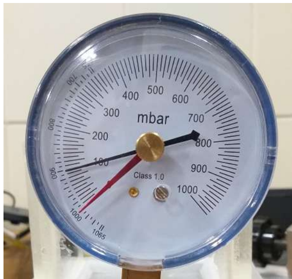
Figura 23 – Medidor analógico de pressão com resolução de 10 mbar.
