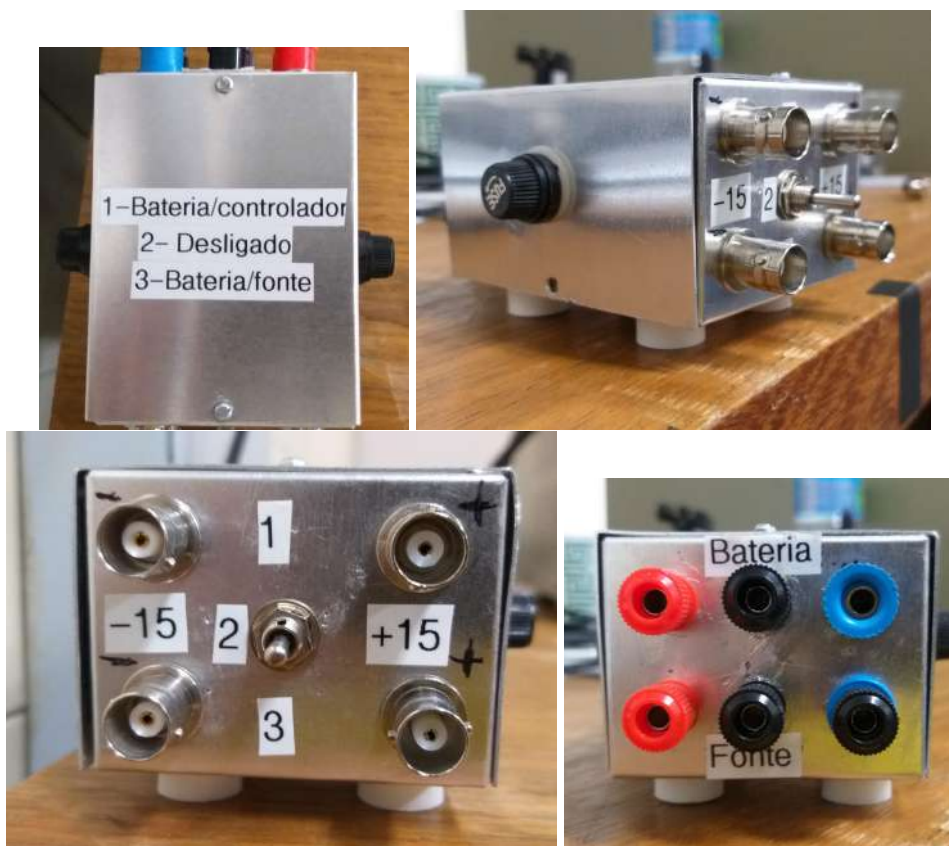
Figura 29 – Painel de controle das baterias. Ele foi desenvolvido para facilitar a ligação das baterias aos controladores, além de permitir conectar uma fonte de carga, em caso de um eventual descarregamento delas.
