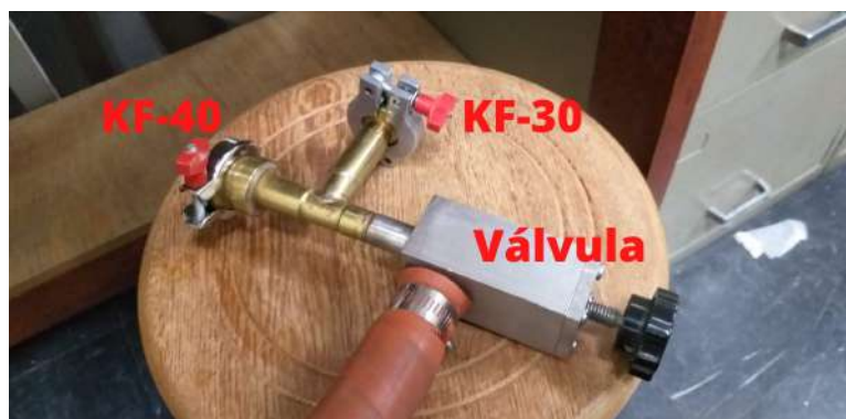
Figura 24 – Válvula homemade inserida no sistema de forma a realizar o vácuo no laser . Ela possui duas flanges, a KF-30 que é usada para conectar ao laser no momento da evacuação; e a KF-40 que permanece fechada. A válvula fica continuamente aberta.
