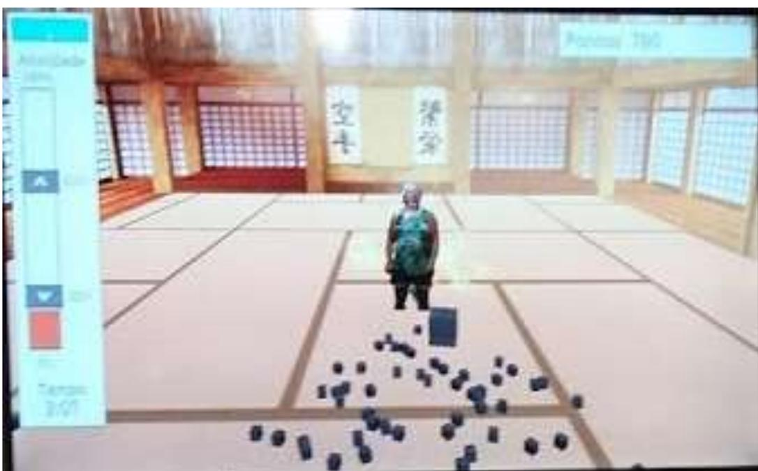
**Figura 4:** Ambiente de realidade virtual do jogo *block breaker*. Da esquerda para direita: percebe-se barra vertical indicando a atividade elétrica captada pela ação muscular da região supra hioidea (expressa em porcentagem) e o tempo de execução do jogo; observa-se ainda, sala em ambiente virtual com a figura de uma mulher participando dessa atividade, bem como a possibilidade de ver sua pontuação expressa na barra superior direita da tela do jogo.
