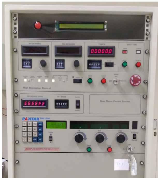
Figura 34 – Painel de controle do equipamento Pantak® HF160
