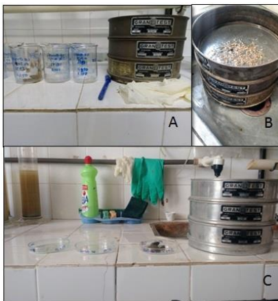
Figura 6. Procedimento laboratorial para tratamento das amostras. A) Amostras nomeadas, B) Peneiramento, C) Amostras pós-peneiramento seguindo para secagem em estufa.
