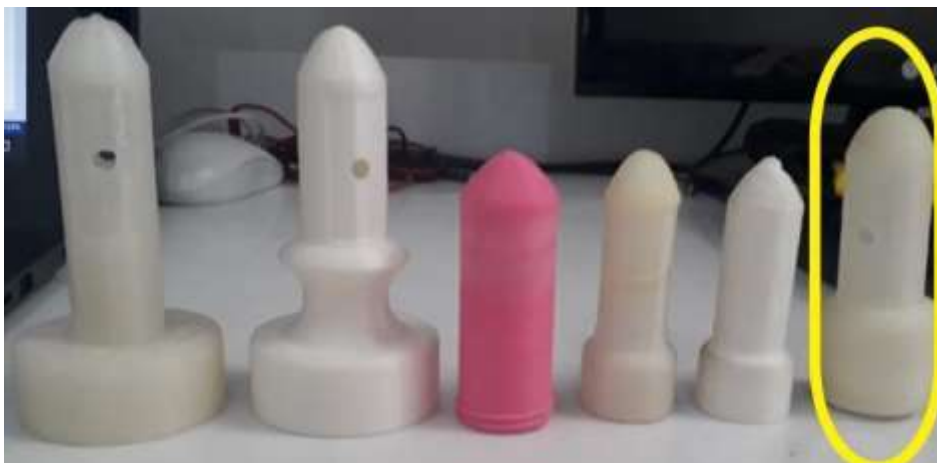
Figura 12 - Montagem de teste do transdutor intravaginal.
