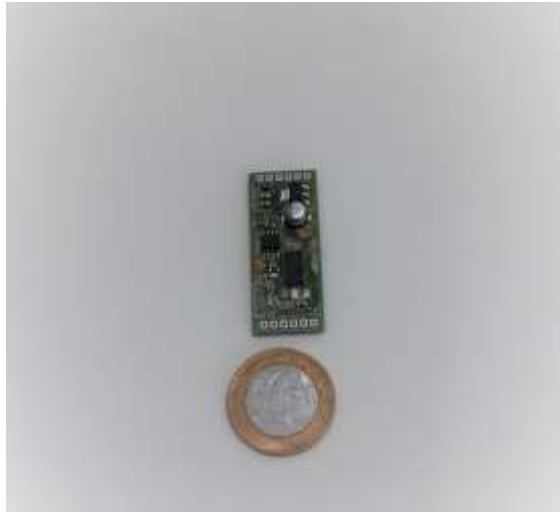
Figura 16 - Placa do transdutor proposto com o auxílio do software proteus 8 em tamanho real, 5 centímetros.
