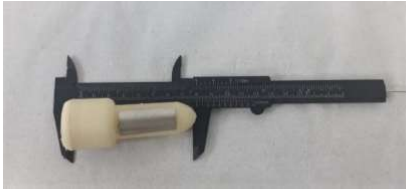
Figura 13 - Protótipo final do transdutor intravaginal com altura total do transdutor é de 82 mm.
