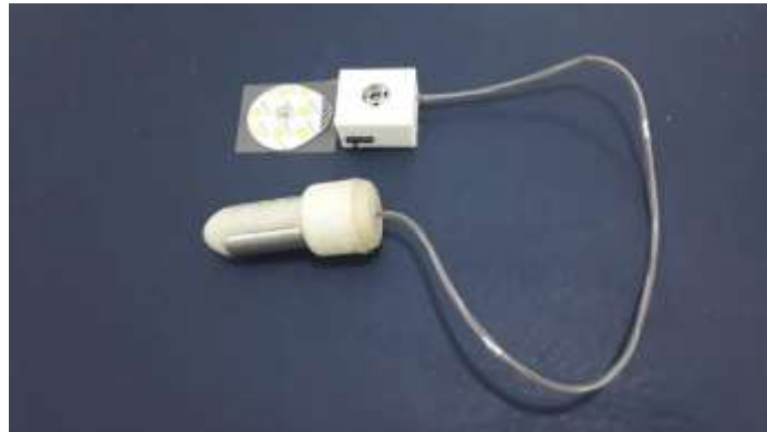
Figura 15 - Eletrodo montado com circuito embutido, caixa de bateria e eletrodo externo de contato revestido com sonda.
