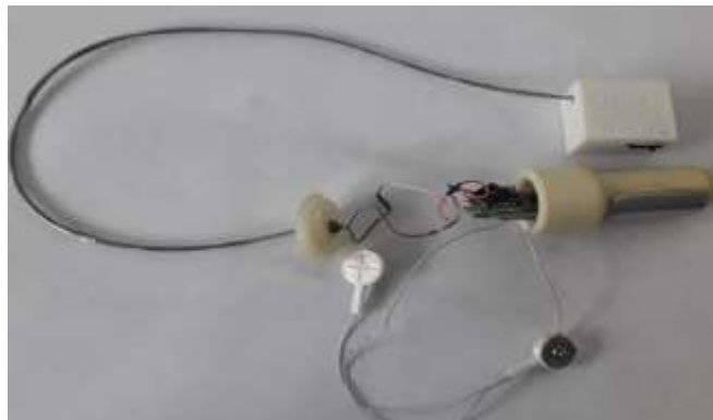
Figura 14 - Protótipo final do transdutor intravaginal com montagem de circuito interno e fio condutor.
