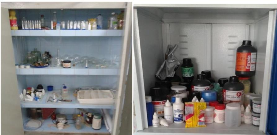
**Figura 4.** Armários com reagentes químicos sem identificação adequada
