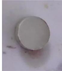
A calcinação foi realizada após a produção dos Pó prensados, os mesmos foram inseridos nos recipientes, que foram tampados com moldes da mesma argila, e levados ao forno Mufla durante 1h a 400 °C (C-NpZnO:400) e 600 °C (C-NpZnO:600). Na figura 27 observa-se o diagrama ilustrativo para o processo de calcinação dos Pó prensados da resina polimérica no recipiente fechado.
