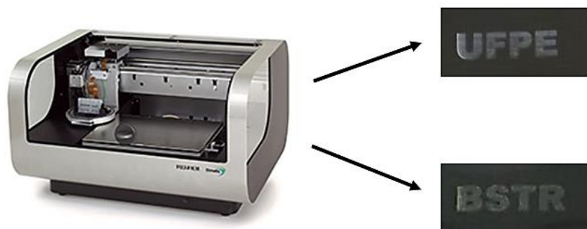
Figura 30 - Dispositivo híbrido com multiestímulo de segurança (DHMS) confeccionados a partir da impressão das tintas contendo os híbridos MCM48-EuBTC (dispositivo BSTR) e MCM48-EuDAMIC (dispositivo UFPE)
