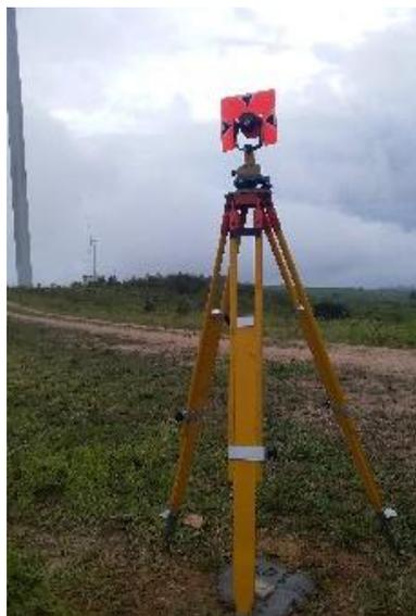
(B) prisma instalado a partir de centragem forçada sobre vértice LP7.
