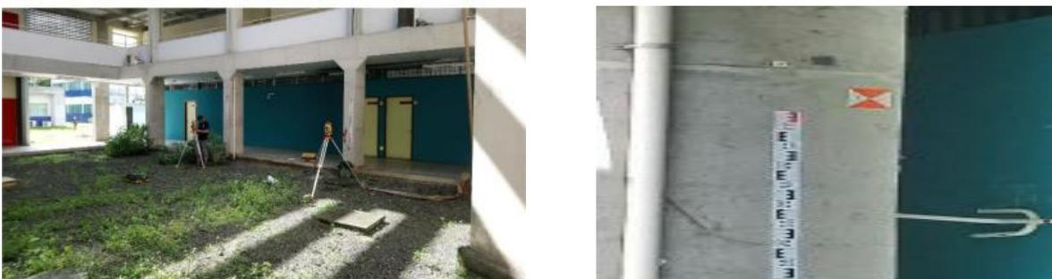
(A) instalação das estações totais em pontos fixos materializados no solo.
