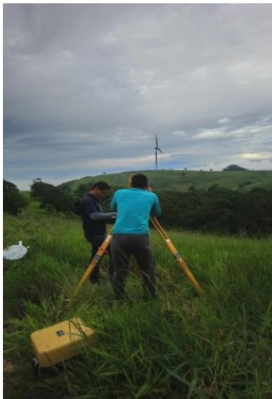
(A) estação total posicionada sobre vértice LP9.
