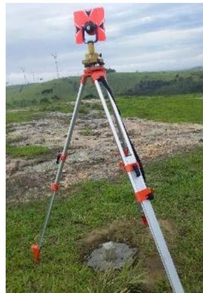
(C) prisma instalado a partir de centragem forçada sobre vértice LP8.
