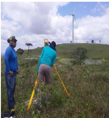
(A) posicionamento da estação total sobre vértice L3.
