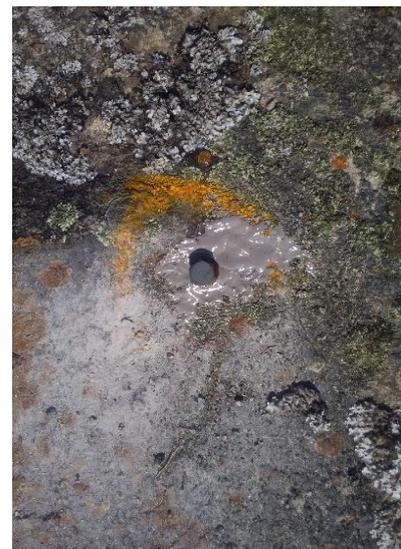
(D) conjunto parafuso fêmea e parafuso macho fixados no ponto-objeto PO02.
