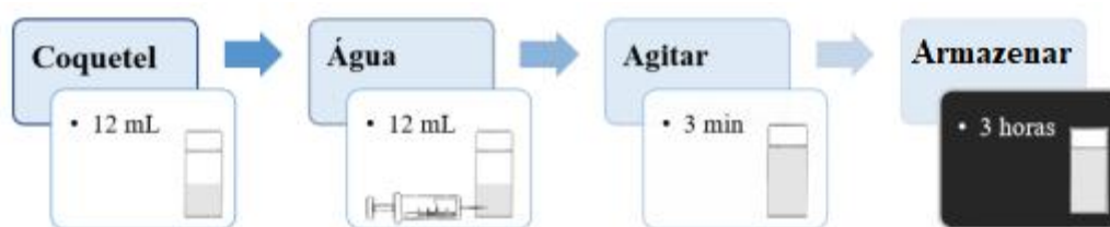
Figura 11 – Metodologia de amostragem para determinação de ^{222}\text{Rn} em águas naturais.
