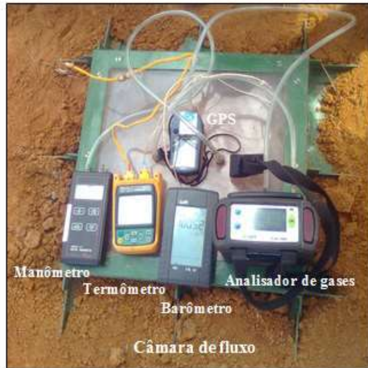
Figura 10 – Equipamentos utilizados para ensaio de Placa
