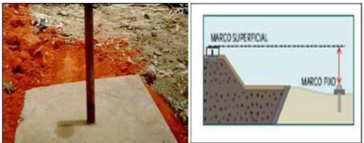
Figura 8 – Marco superficial e esquema ilustrativo de medição de recalques
