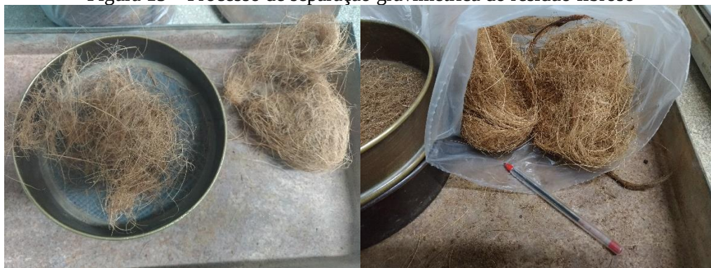
Figura 15 – Processo de separação gravimétrica do resíduo fibroso
