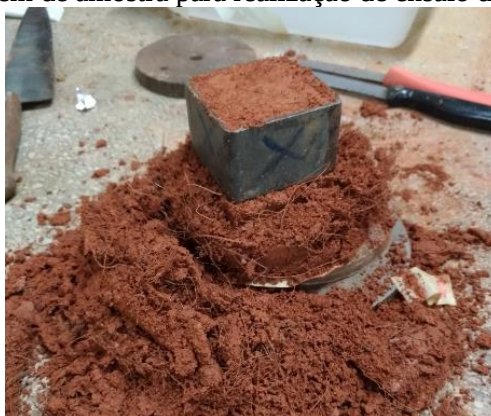
Figura 26 – Moldagem de amostra para realização de ensaio de cisalhamento direto
