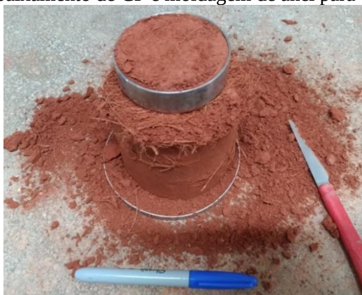
Figura 19 – Rebaixamento de CP e moldagem de anel para ensaio de sucção
