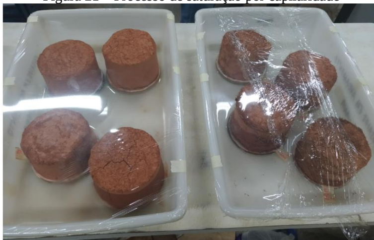
Figura 21 – Processo de saturação por capilaridade
