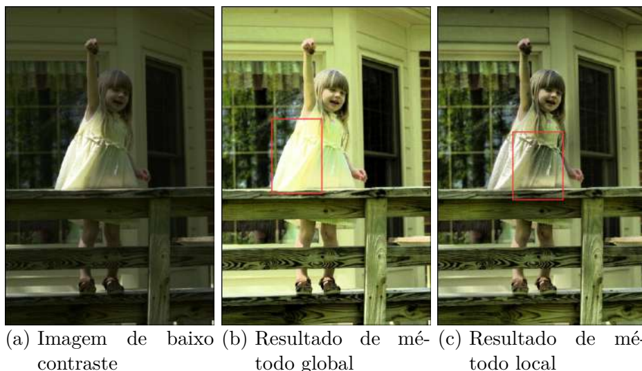
Figura 5 – Exemplo de aprimoramento de contraste por método local e global.
