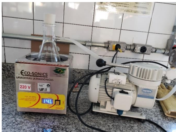
Figura 10 - Combinação de ultrassom e vácuo utilizados como pré-tratamento das amostras de melão.
