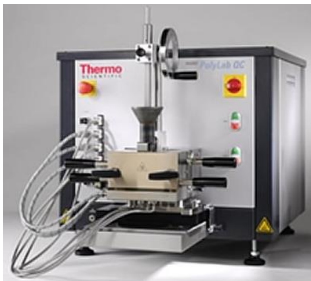
Figura 11 - Misturador interno Haake Rheomix 3000.
