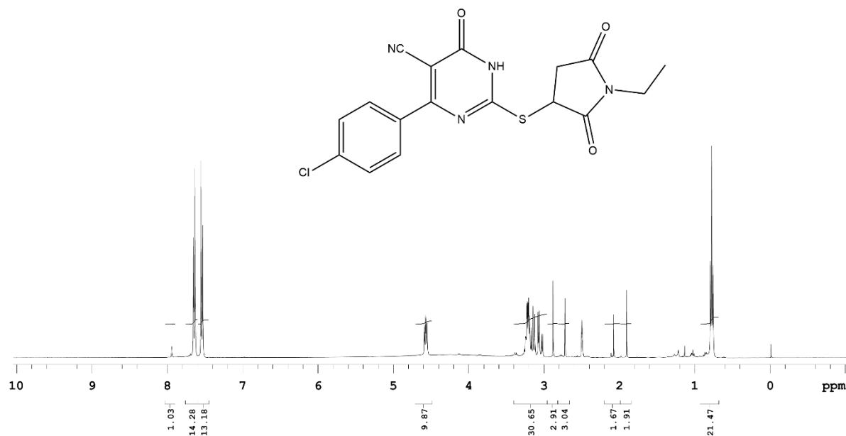
FIGURA 90 – Espectro de RMN de ^1\text{H} (400 MHz, \text{DMSO-d}_6 ) do 2-[(Etil-2,5-dioxopirrolidin-3-il)tio]-6-oxo-4-(4-cloro-fenil)-1,6-diidropirimidinona-5-carbonitrila 14e .
