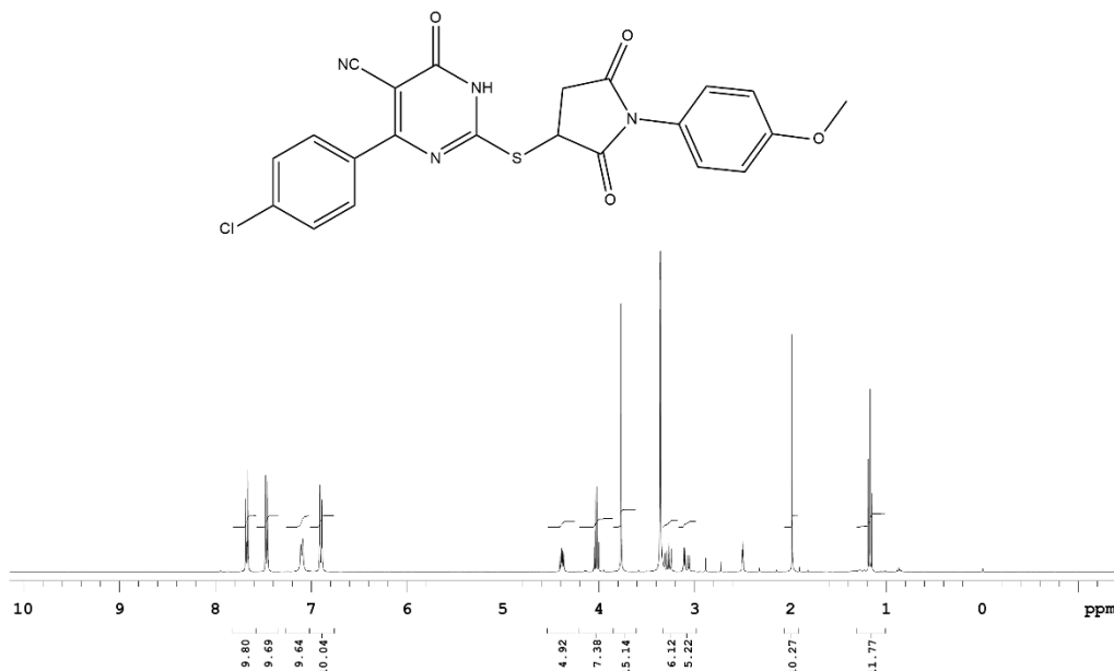
FIGURA 40 – Espectro de RMN de 1 H (400 MHz, DMSO d6 ) do 2-[[[4-Metóxi-fenil)-2,5-dioxopirrolidin-3-il]tio)-6-oxo-4-(4-cloro-fenil)-1,6-diidropirimidinona-5-carbonitrila 10j .
