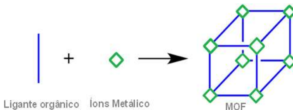
Figura 1. Representação simplificada da estrutura de um MOF.
