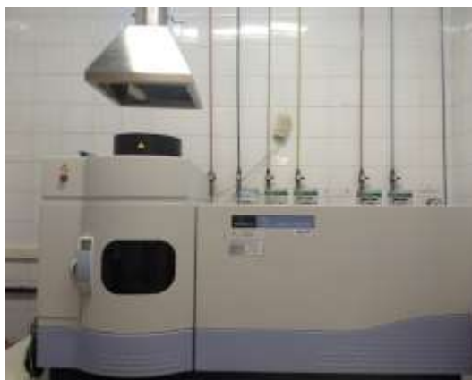
Figura 11. Espectrômetro de emissão óptica com plasma indutivamente acoplado (ICP OES).
