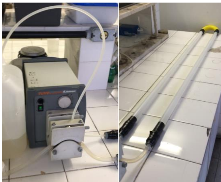
Figura 9 - Sistema de tubulação com lâmpadas fluorescentes, bomba peristáltica e tanque de armazenamento.
