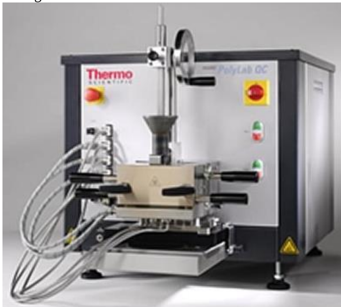
Figura 6 - Misturador interno Haake Rheomix 3000.
