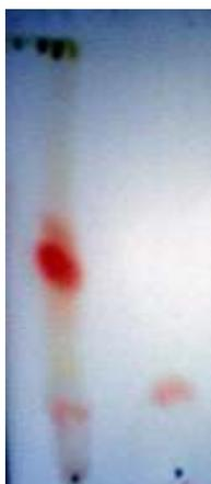
**Figura 4**-Cromatograma de caracterização de açúcares redutores – **HE** de M. jalapa; **P**- Padrões de glicose e rhamnose.
