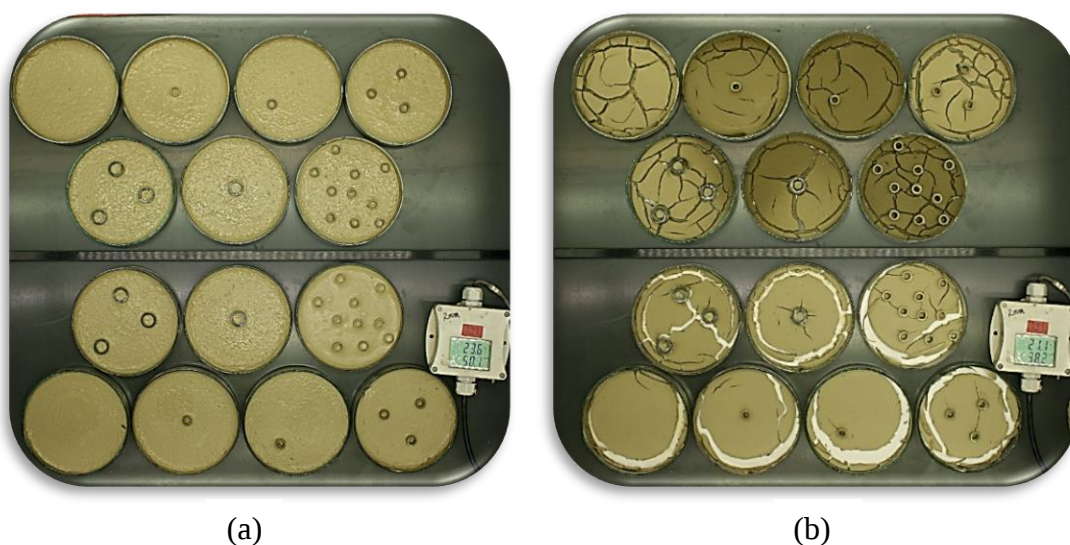
Figura 13 - Visão geral de todas as amostras no (a) início e no (b) final do ensaio de secagem, 335h
