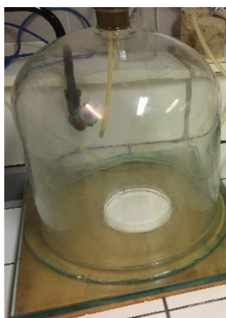
Figura 6- Cápsula com teflon preenchida com água testada em uma máquina a vácuo.
