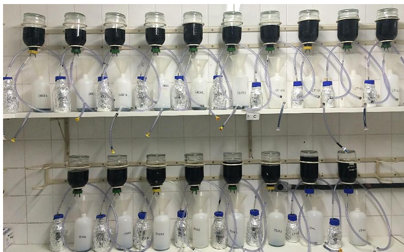
Figura 19 - Aparato experimental para monitoramento da produção diária de \text{CH}_4
