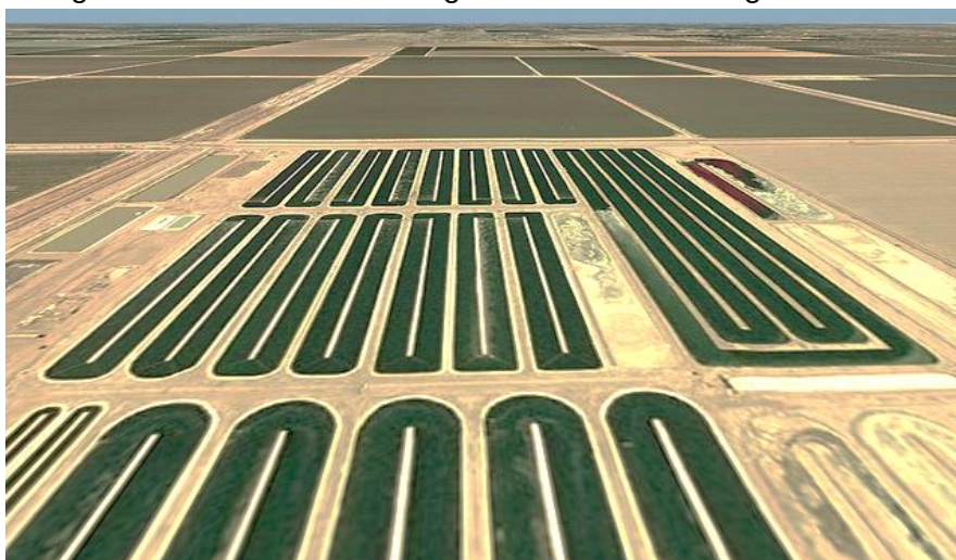
Figura 3 - Cultivo de microalgas em sistema de lagoas abertas
