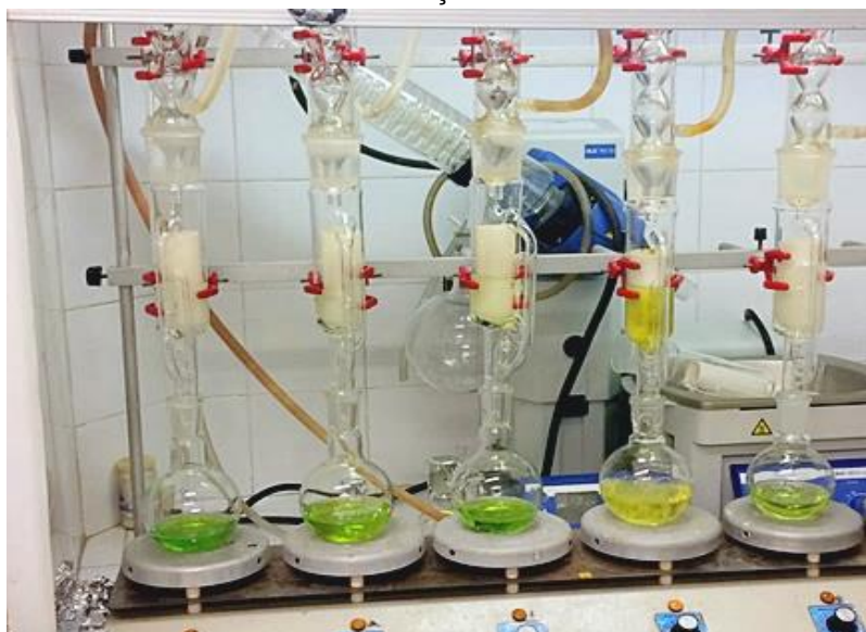
Figura 12 - Extração de lipídios da biomassa de Chlorella vulgaris utilizando o método de extração Soxhlet
