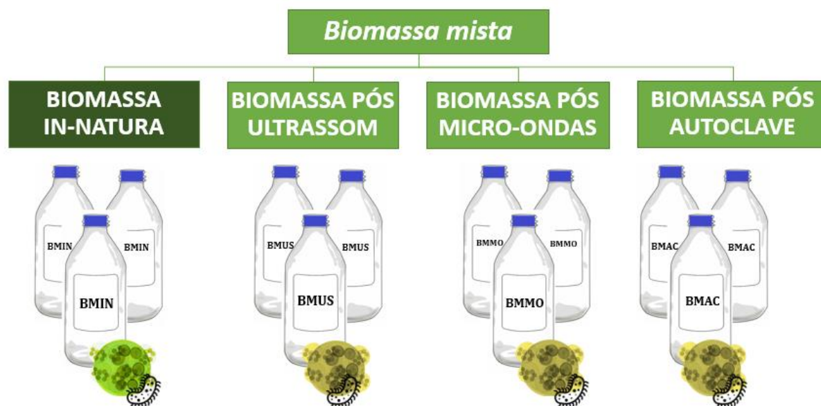
Figura 16 - Configuração dos experimentos realizados para avaliação da biodegradabilidade metanogênica de biomassa mista de microalgas e cianobactérias
