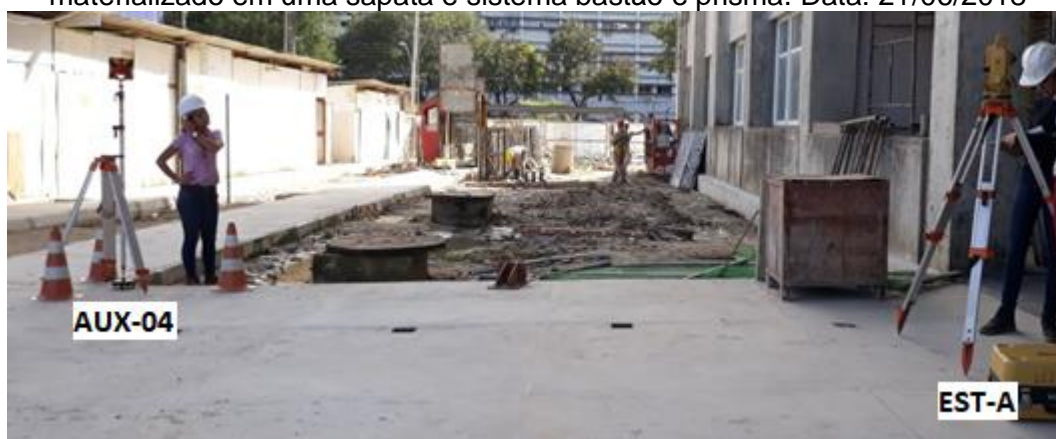
Figura 53 - Visada a ré do vértice EST-A para o vértice AUX-04 materializado em uma sapata e sistema bastão e prisma. Data: 21/06/2018
