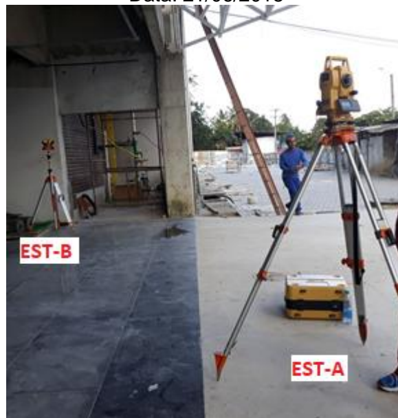
Figura 55 - Irradiação de EST-B por EST-A Data: 21/06/2018
