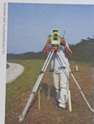
O teodolito é um instrumento utilizado em trabalhos geodésios e topográficos.
