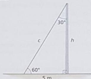
Nesse caso, para calcular o comprimento do cabo, representado por  $c$ , usamos o seno de  $30^\circ$ :
