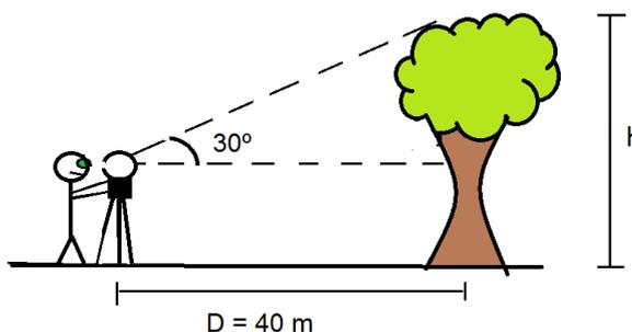
**P:** Eu não sei se comentei com vocês nas aulas anteriores que, quando trabalho com tangente e não tenho a calculadora, se eu quiser medir qualquer altura de qualquer objeto, não tenho calculadora, só tenho instrumento que mede o ângulo, não tenho a tabela dos valores dos ângulos, nem de seno, cosseno e tangente. Não estou lembrado dos valores dos principais ângulos. Qual seria alternativa? Eu me aproximo da árvore e, à medida que eu vou me aproximando, o ângulo diminui ou aumenta?
