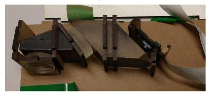
Figura 59 - Lentes e prismas extraídos do tubo óptico de um microscópio. Fonte: Autor
