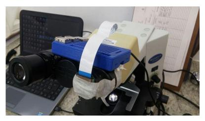
Figura 57 - Câmera acoplada ao microscópio. Fonte: Autor.
