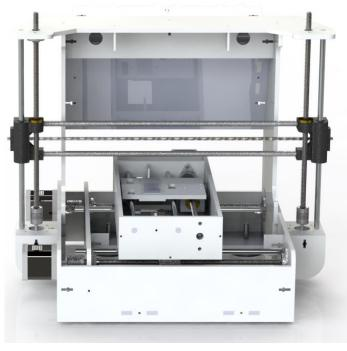
Figura 61 - Novo sistema mecânico montado com os eixos X, Y e Z. Fonte: Autor.
