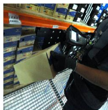
Processo de "picking": por wireless, os funcionários recebem os pedidos em seus coletores e identificam onde os produtos estão localizados, já que foram registrados na entrada
