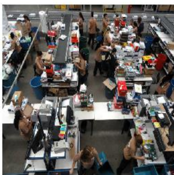
Caixas e empacotadoras, no CD: após o picking, os produtos são enviados para empacotamento e depois colocados na esteira, para a distribuição (caso não haja personalização)
