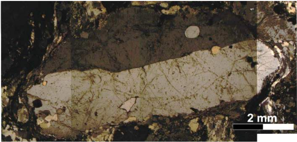
Figura 59: Porfiroclasto milimétrico de feldspato orientado na matriz a polaroides cruzados.
