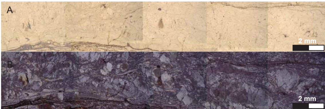
Figura 107: Textura da rocha evidenciando trama S-C, caracterizada pelos cristais recristalizados de quartzo e feldspatos bordejando os porfiroclastos de feldspato a polaroides (A) paralelos e (B) cruzados.
