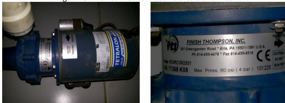
Figura 25 - Bomba KC3 utilizada no ensaio dinâmico
