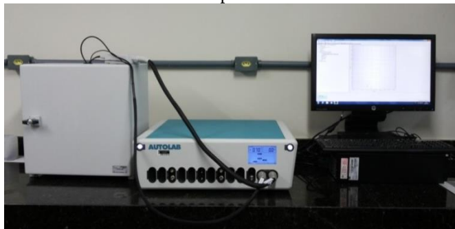
Figura 23 - Gaiola de Faraday e potenciostato acoplado ao computador
