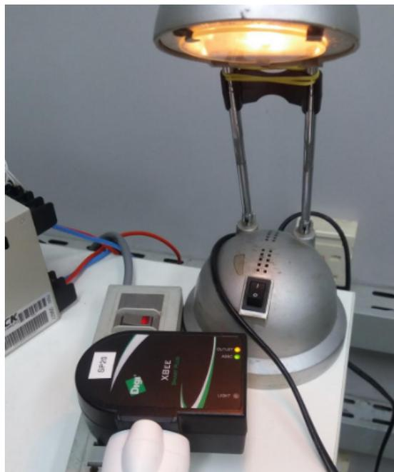
Figura 4 – *Smartplug* da fabricante Digi utilizado no estudo da comunicação Xbee.
