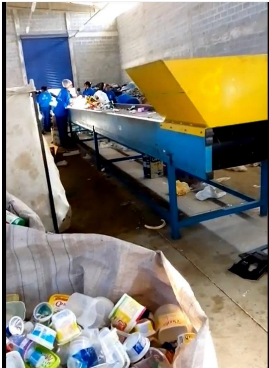
Figura 6 - Mesa de Triagem alocada no sentido errado e usada com a esteira desligada.
