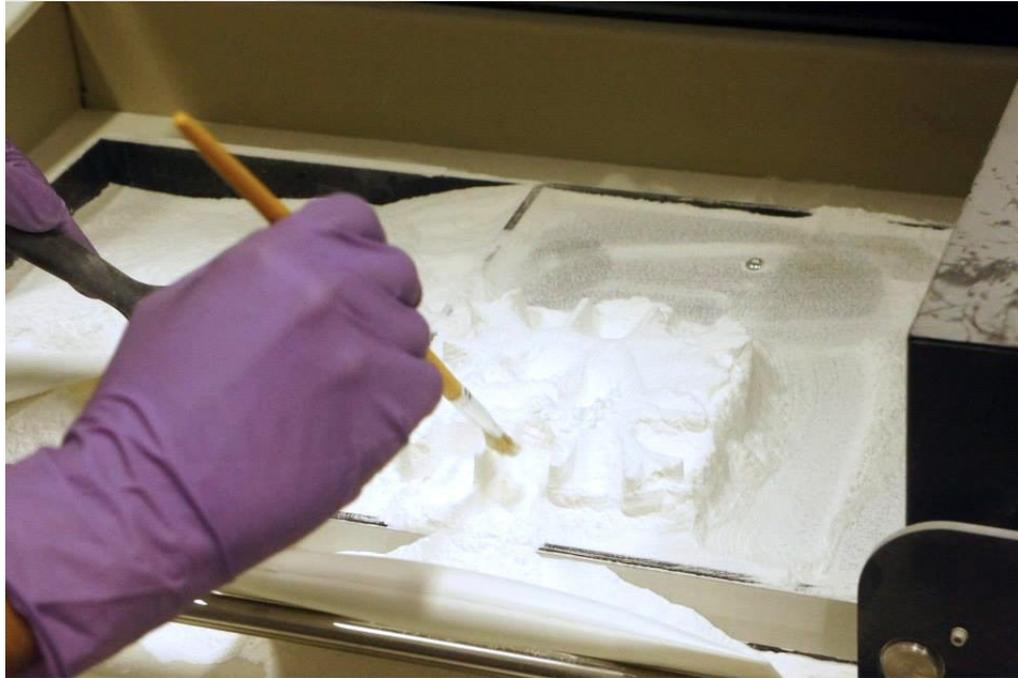
Imagem 67 e 68. Retirada do elemento impresso do reservatório do modelo.
