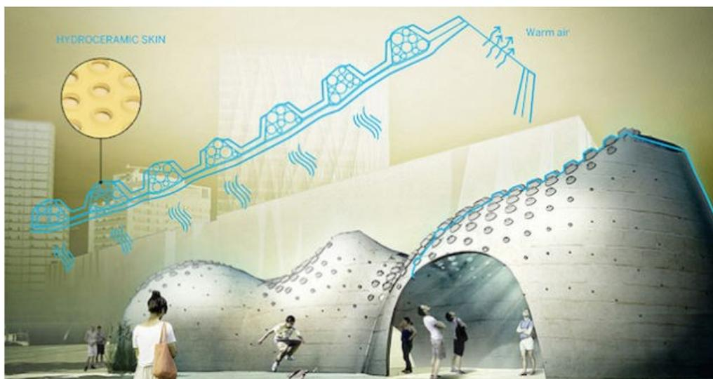
Imagem 13 *Hydroceramic skin*. Material produzido no *Institute for Advanced Architecture of Catalonia em Barcelona*. Intenciona reproduzir um sistema de resfriamento passivo mais eficiente para envoltórias. Utiliza princípios de emulação da transpiração, semelhantes ao que ocorre com o suor da pele. Fonte: Rathee *et al.* (2014)
