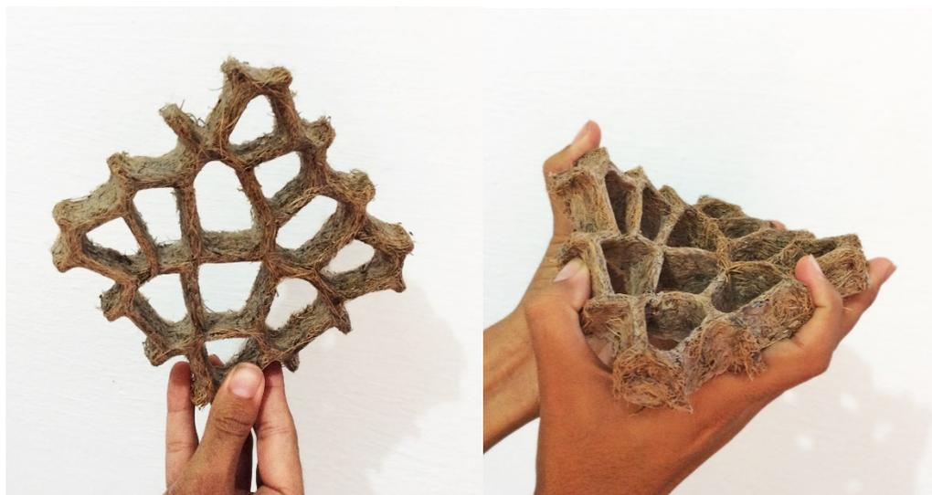
Imagem 76 e 77 A esquerda, elemento ao ser retirado da fôrma. A direita, as propriedades da resina permite curvatura do elemento. Fonte: autor.
