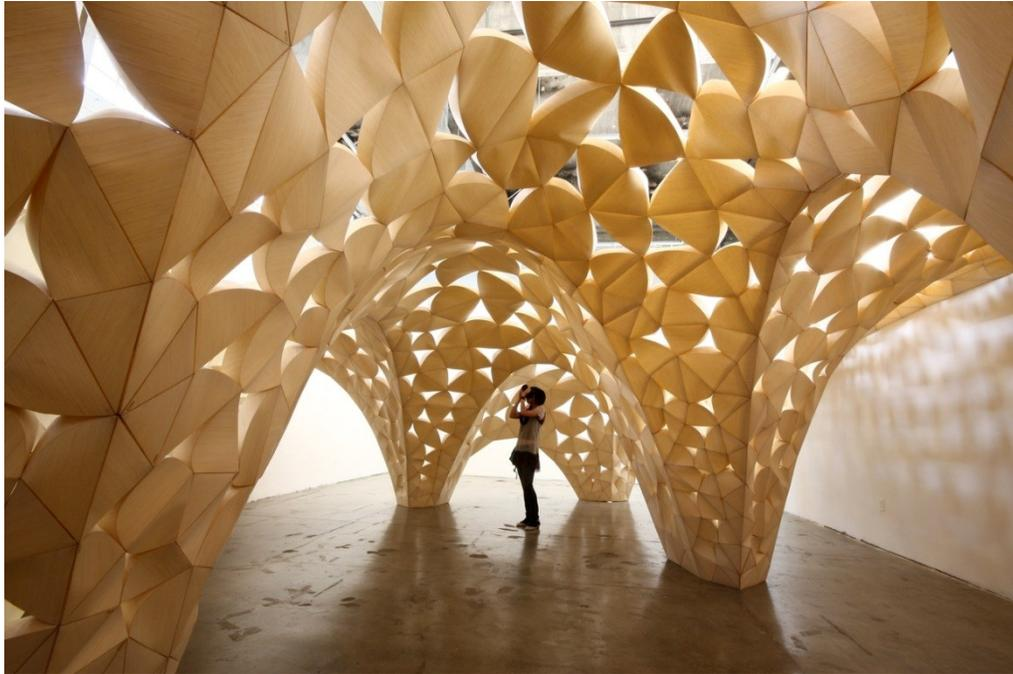
Imagem 34. Exemplo de aplicação da técnica de tesselação em Fabricação digital. Fonte: Iwamoto (2008)
