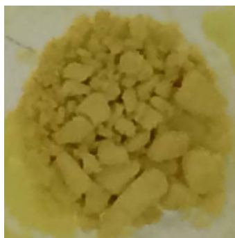
Figura 31 – Pó da ZIF-8-90-Gly Salt funcionalizada com INH
