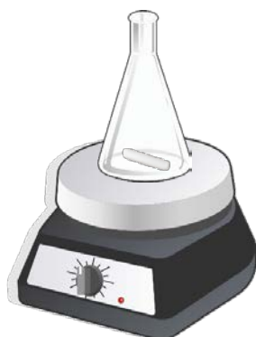
Figura 10 – Solução 2 em homogeneização com agitador magnético sob T.A.
