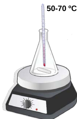
Figura 9 – Solução 1 em agitação com aquecimento.
