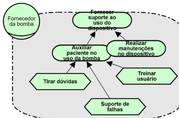
Figura 38 – Ator Fornecedor da bomba - Parte 4 do modelo SR, com iStar4Safety, do exemplo do Sistema da Bomba de Insulina, desenvolvido com a ferramenta piStar-4Safety.
