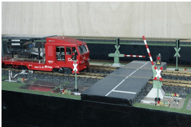
Figura 41 – Experimento simulando o Sistema de Controle de Travessia de Ferrovia criado para validação.
