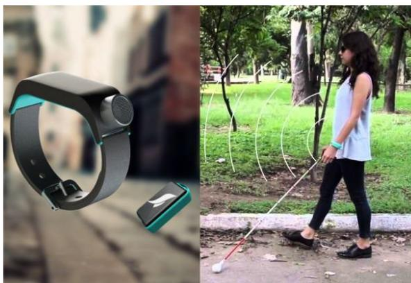
**Figura 1.** O bracelete Sunu (à esquerda) emite ondas sonoras que ajudam o cego, ou pessoa com baixa visão, a perceber a distância espacial de objetos em seu entorno.
