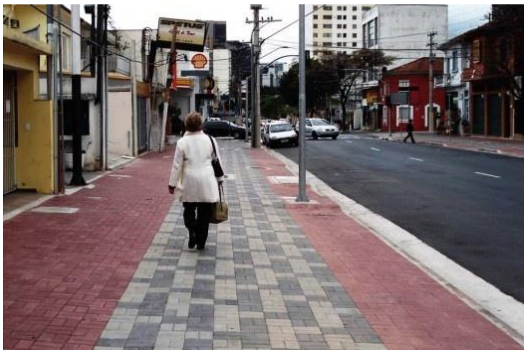
Figura 57: Exemplo de configuração de piso que determina a separação de faixas
