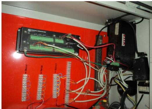
**Figura 54** – Sistema de aquisição de dados (datalogger)
