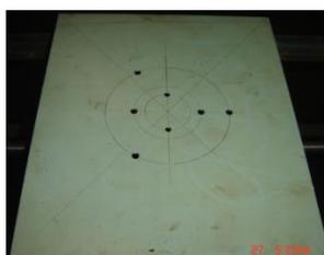
**Figura 42** – Furação das bases horizontais para comportar um piranômetro
