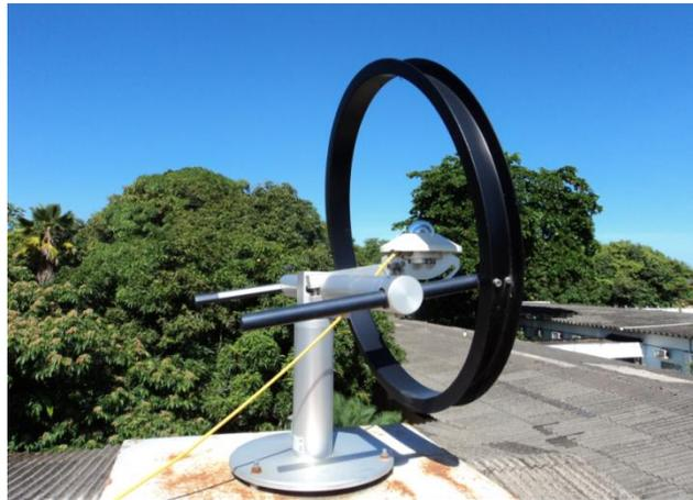
**Figura 17**– Fotografia de um anel de sombreamento de Drummond da Kipp & Zonen usado como referência
