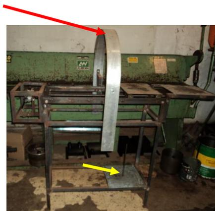
**Figura 43** – Fixação do arco de anel de sombreamento do MEA e Gnomon
