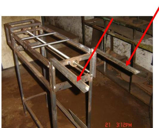
**Figura 41** – Estrutura de sustentação da base horizontal fixa
