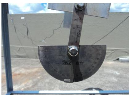
**Figura 53**– Transferidor de ângulo acoplado ao anel de sombreamento
