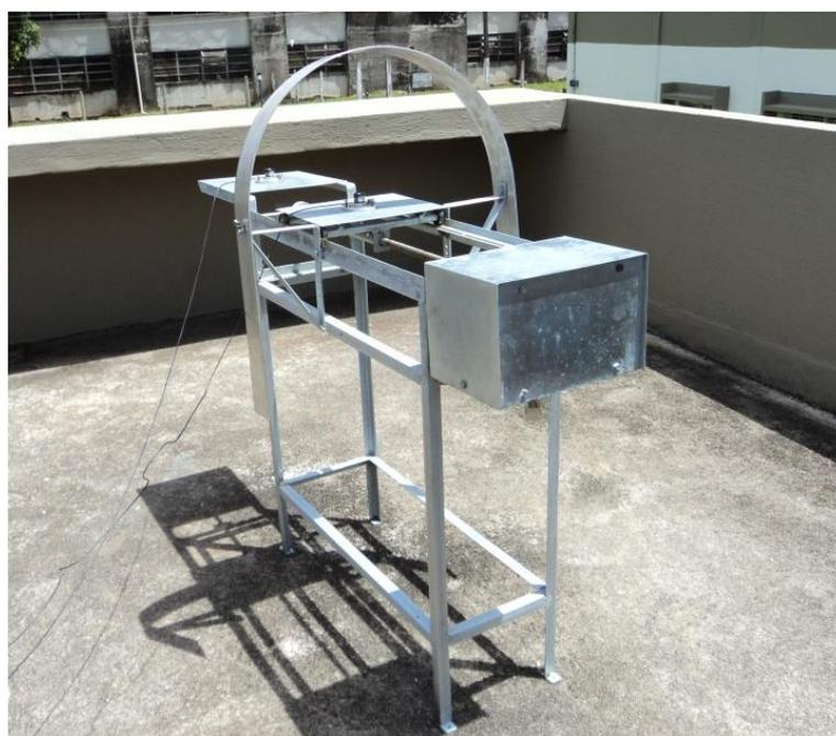
**Figura 44** – Estrutura mecânica do MEA galvanizada
