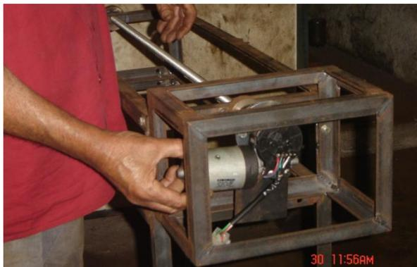
**Figura 38** – Construção da caixa de sustentação e proteção do motor DC
