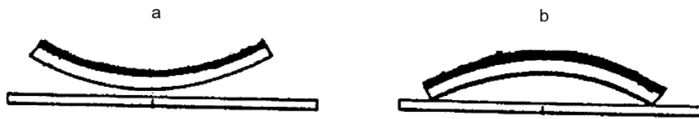
Figura 53 - Tensão de crescimento do filme sobre o substrato. (a) tensão por expansão. (b) tensão por compressão.
