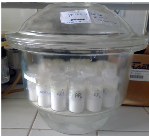
Figura 7 – Teste de Permeabilidade ao Vapor de Água
