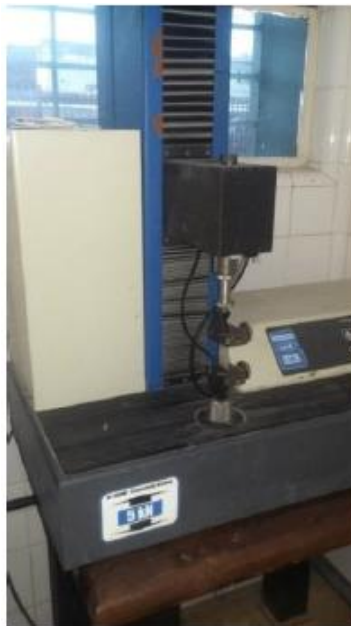
Figura 8 – Equipamento de Ensaio de Tração EMIC
