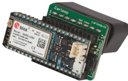
Figura 30 – Placa de desenvolvimento *Particle Electron* com a plataforma *Carloop* integrada
